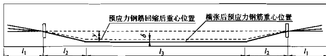
图 5.3.2 锚固定位引起预应力钢筋的回缩
