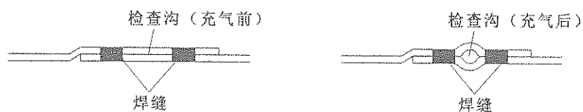
防水板焊缝检查示意图
