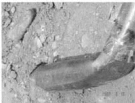
图6 沉降管发生弯曲
